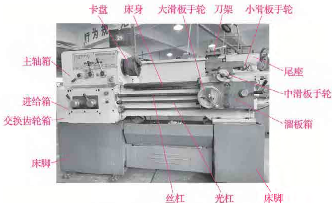
图 1-2 C6132A 型车床的结构
