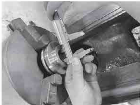
图 6-3 用游标卡尺检测孔径
