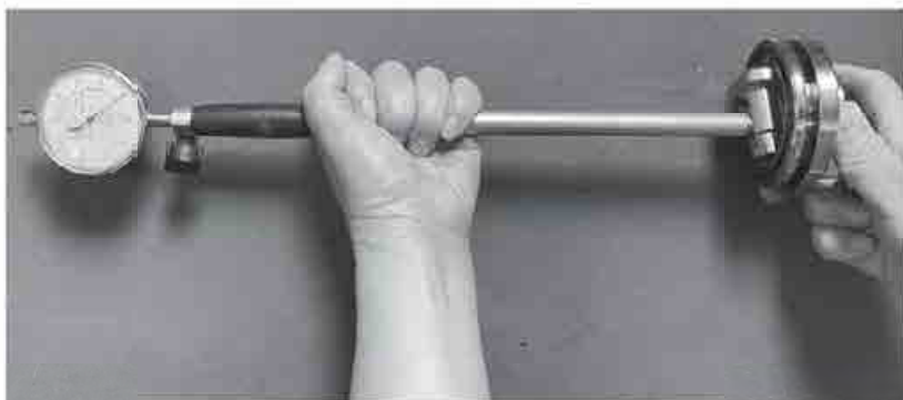
图 6-5 用内径杠杆百分表检测孔径
