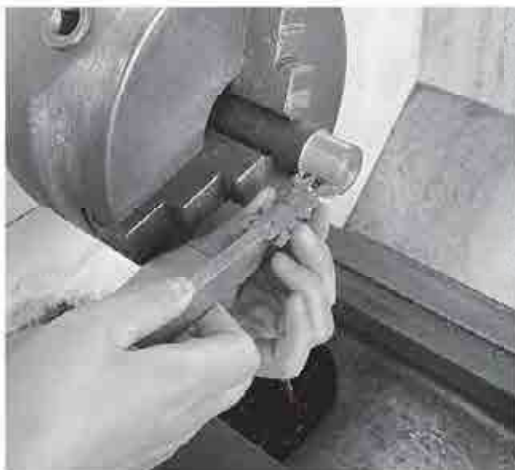
图 8-2 用角度样板找正
