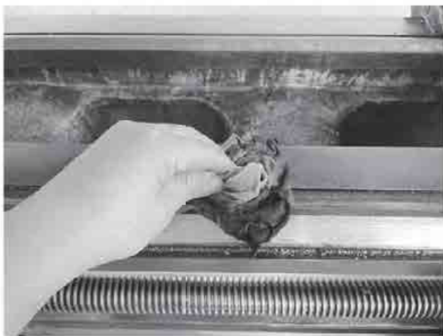
图 1-12 擦拭床身和中、小滑板导轨面
